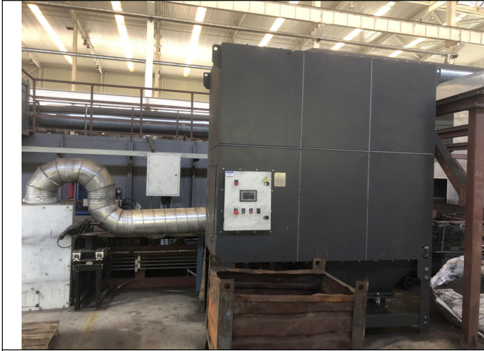
清理工部砂轮机粉尘处理设施“旋风除尘器+布袋除尘器” (TA030)
