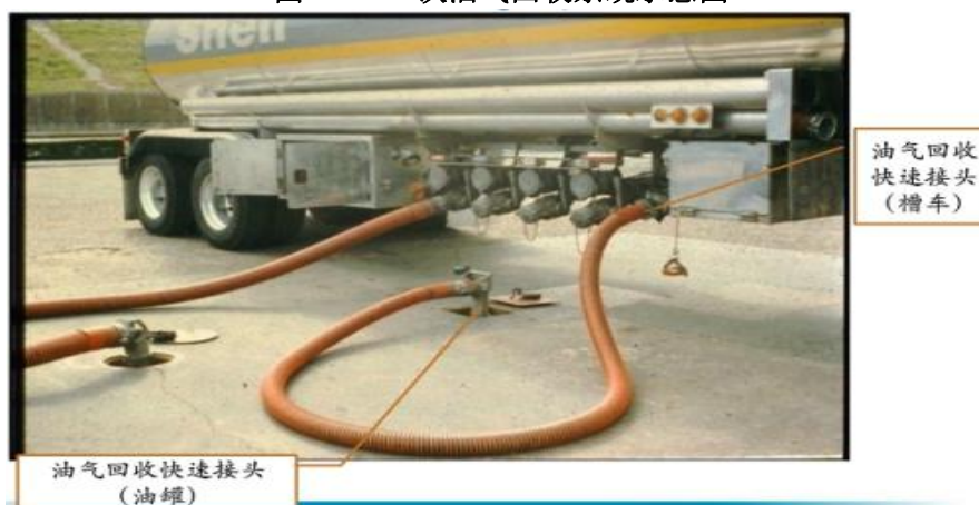
图 2-3 一次油气回收实例图
