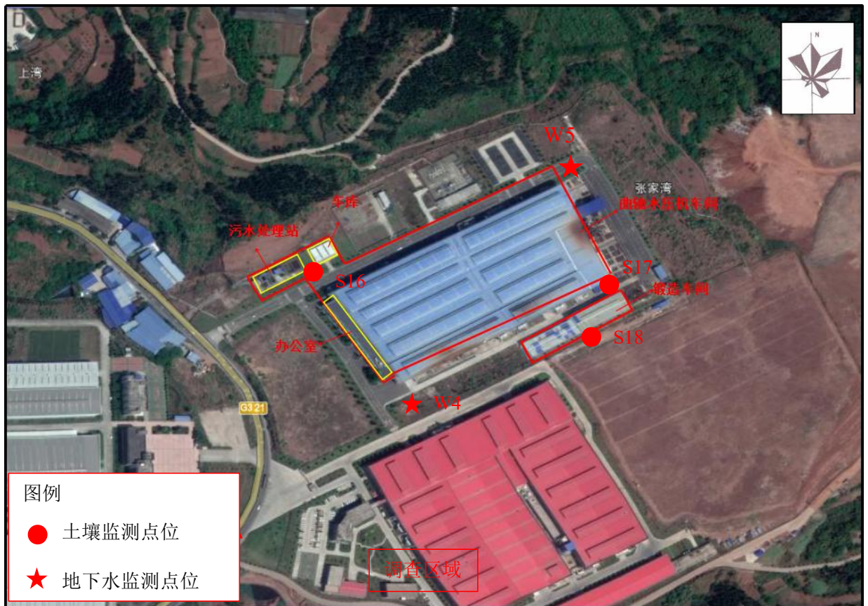
图7.2-3 锻造事业部和曲轴事业部水压机作业区土壤及地下水布点图
